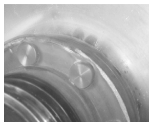
图2 主轴气封部位摩擦损伤
