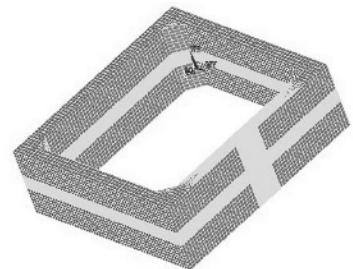
图1 空心薄壁墩切槽法计算模型
